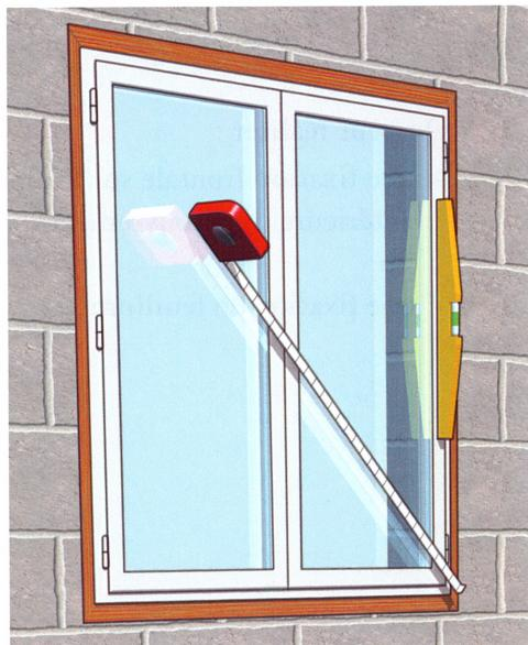
Avant de fixer les menuiseries (ou le seul dormant) dans le bâti existant, il faut vérifier les diagonales, le niveau et l'aplomb des menuiseries ainsi calées.
