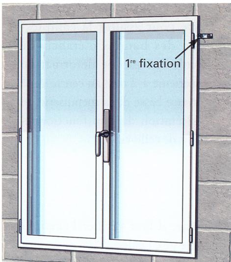
Avant de fixer la menuiserie sur le gros œuvre, il faut contrôler que la réservation entre le châssis et la maçonnerie, nécessaire à la mise en place du fond de joint et du mastic (5 mm minimum), est effective et, au besoin, l'obtenir en intercalant des cales entre les pattes et le gros œuvre.
