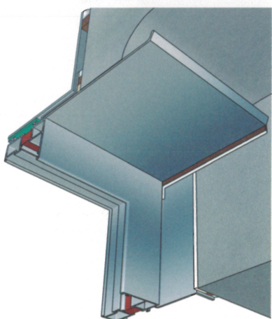
Phase 2 : après mise en place de la bavette Étanchéité périphérique sur menuiserie aluminium à cadre tournant.
