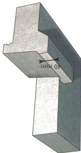
Appui coulé en place
